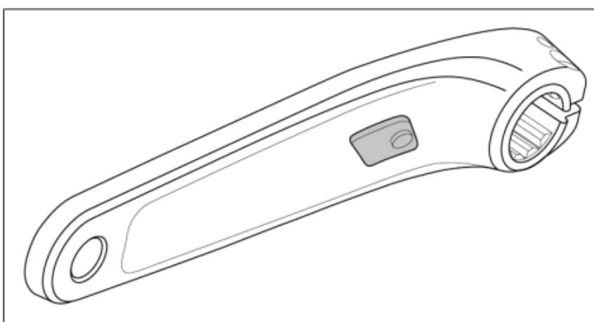
Het schakelen met Pinion Smart.Shift is afgestemd op de trapfrequentie. Daarvoor is de linker crankarm aan de binnenkant uitgerust met een sensormagneet. Het gebruik van andere standaard Pinion-cranksets is niet mogelijk of toegestaan.
