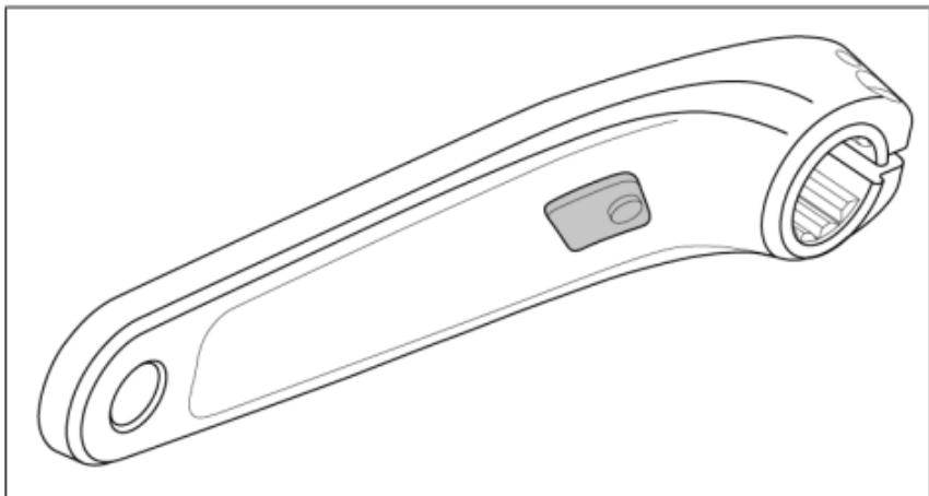
El cambio con Pinion Smart.Shift varía en función de la cadencia de pedaleo. Para ello, el brazo de biela izquierdo está equipado con un sensor magnético en el lado de dentro. No es posible ni está permitido el uso de otros juegos de bielas estándar de Pinion.
